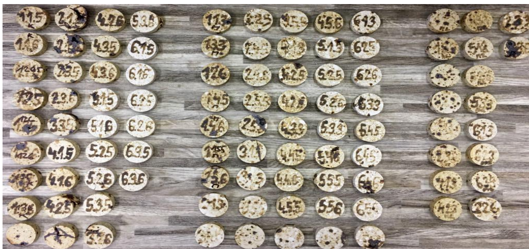
Obr. 21: Vzhled vzorků vypálených při teplotě 1550 °C
