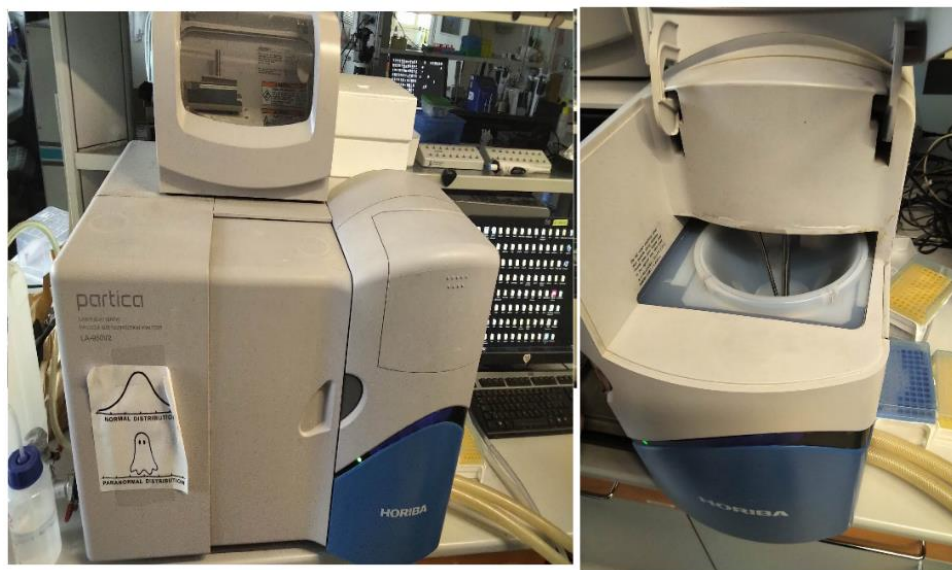
Obr. 8. Přístroj pro granulometrii Partica LA-960V2
