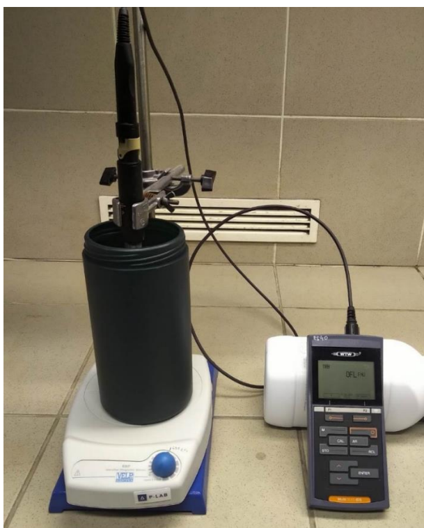
Obr. 9. Aparatura pro turbidimetrické měření
