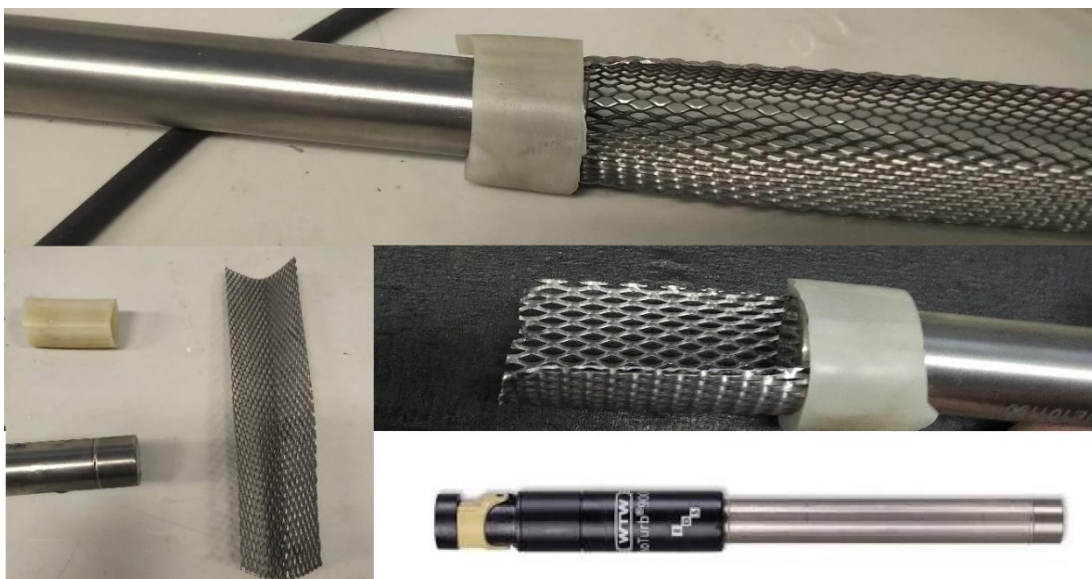
Obr. 14 Turbidimetrické elektroda s a bez ochranné mřížky
