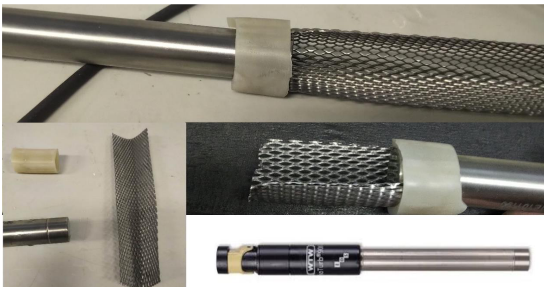
Obr. 14 Turbidimetrické elektroda s a bez ochranné mřížky
