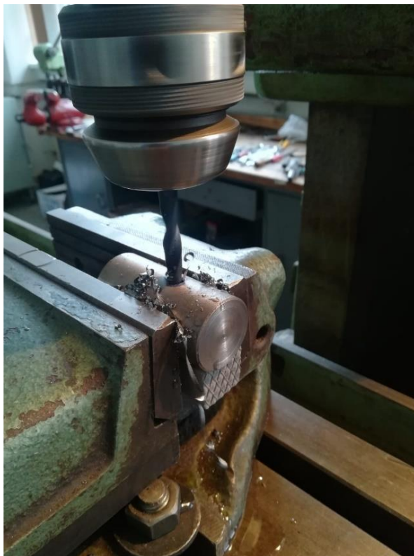
Obrázek 25 - Vrtání přesné díry pro čep
