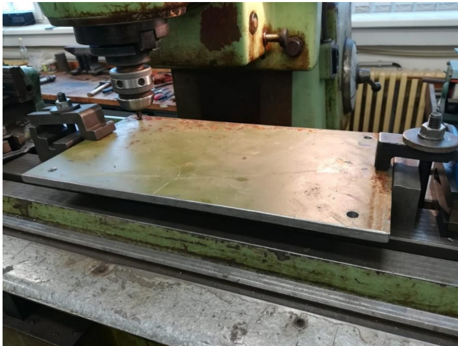
Obrázek 23 - Vrtání přesných děr na spodní desce
