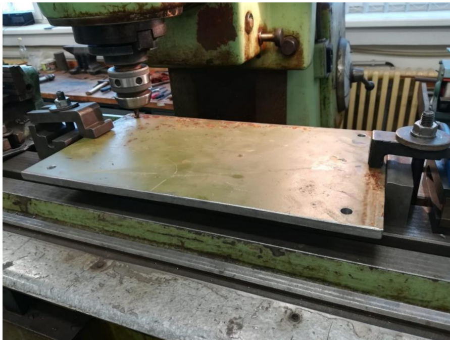
Obrázek 23 - Vrtání přesných děr na spodní desce
