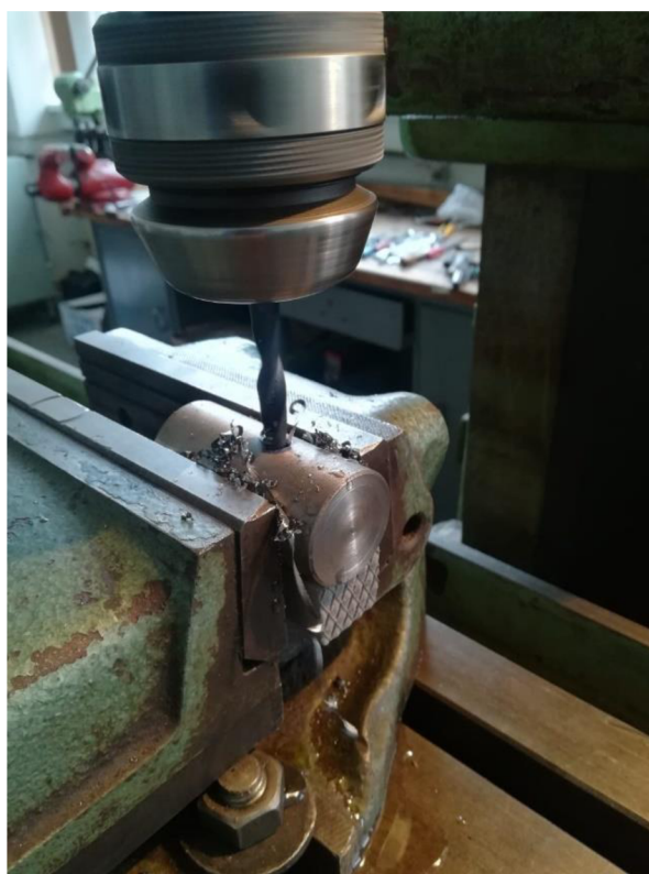
Obrázek 25 - Vrtání přesné díry pro čep
