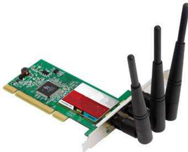
Obrázek 3-2 – Wi-Fi karta pro pásmo 2,4 GHz s 3x3 MIMO technologií.
