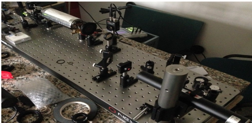
OBRÁZEK 9: MĚŘICÍ SESTAVA. VPRAVO DOLE JE LASER A VLEVO NAHOŘE PAK REZONÁTOR
