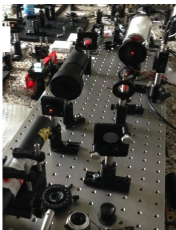
OBRÁZEK 18: ROZŠÍŘENÍ SESTAVY PRO GAUSSOVSKÝ SVAZEK PŘIDÁNÍM EXPANDÉRU (VLEVO UPROSTŘED) A AXICONU (VPRAVO UPROSTŘED)
