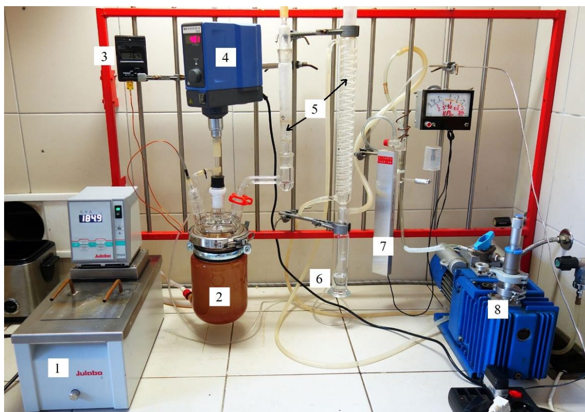
Obrázek 24: Aparatura pro syntézu oligoesteru (1 - cirkulační termostát, 2 - reakční kotlík, 3 - teploměr, 4 - hřídelová míchačka, 5 - systém chladičů, 6 - předloha k odběru reakční vody, 7 - vakuometr, 8 - vývěva)
