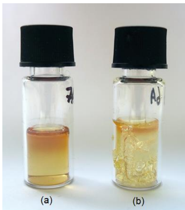
Obrázek 40: Vytvrzená pryskyřice Pentaerythritol (1:24:4) s 60 % VAc iniciována 1 % AIBN (a) a 1,5 % AIBN (b)
