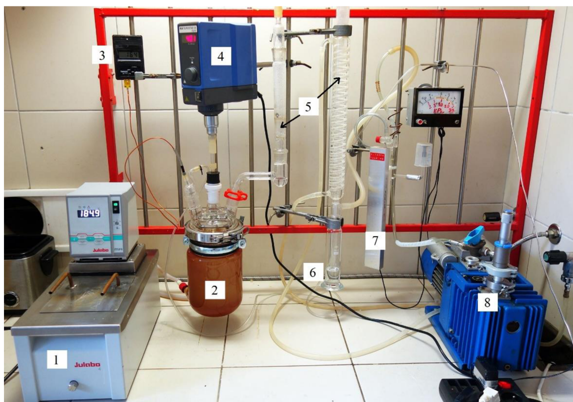
Obrázek 24: Aparatura pro syntézu oligoesteru (1 - cirkulační termostat, 2 - reakční kotlík, 3 - teploměr, 4 - hřídelová míchačka, 5 - systém chladičů, 6 - předloha k odběru reakční vody, 7 - vakuometr, 8 - vývěva)
