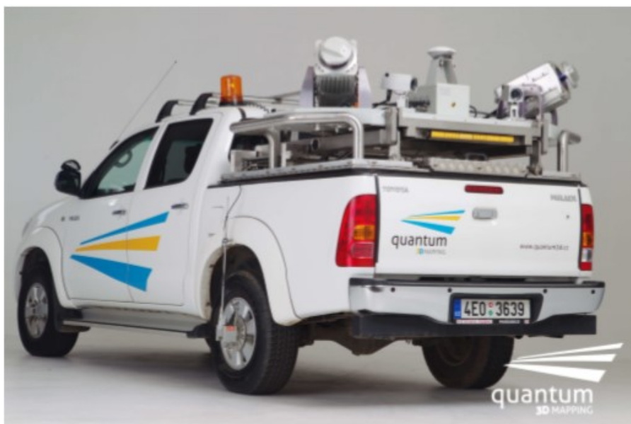
Obrázek 1 Mobilní mapovací systém LYNX (Mobilní mapování, b.r.)
