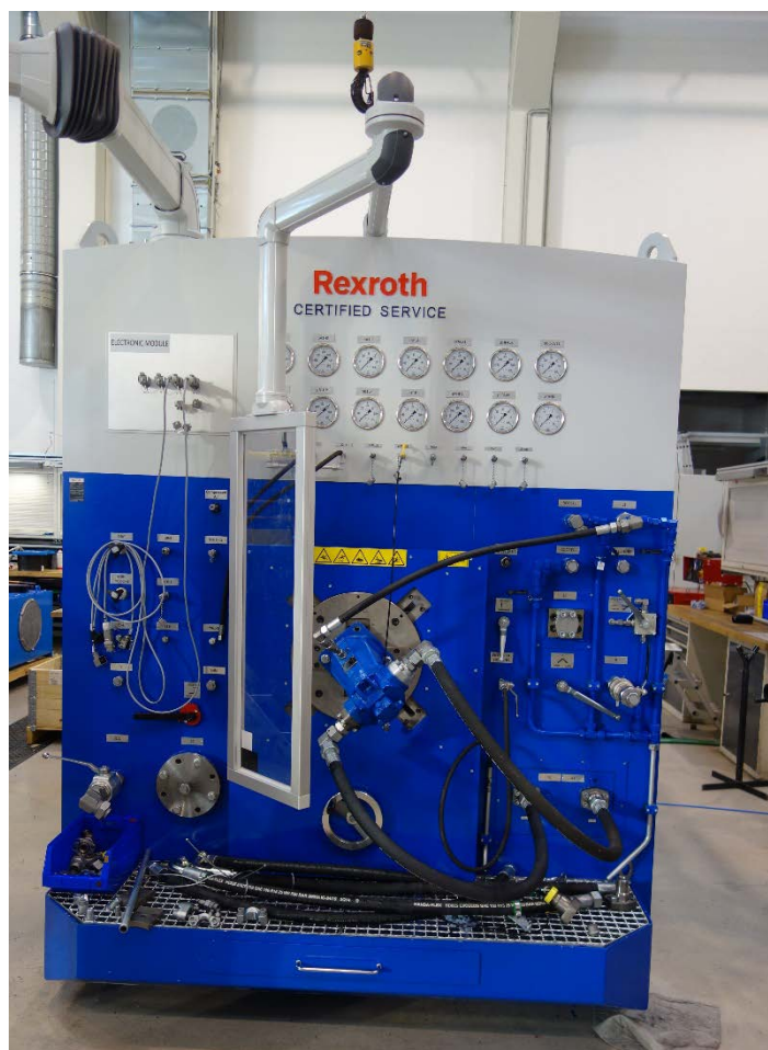
Obr. 6) Stand pro zkoušení a nastavování čerpadel
