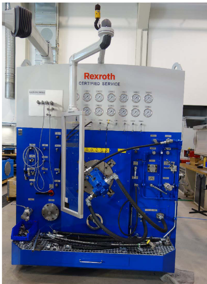
Obr. 6) Stand pro zkoušení a nastavování čerpadel
