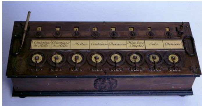
Obrázek 2: Pascalina. Čísla mohla být přičtena otáčením kol (umístěných podél spodní části stroje) ve směru hodinových ručiček a odečtena otáčením kol proti směru hodinových ručiček. Každá číslice ve výsledku byla zobrazena v samostatném okénku, viditelném na vrchu fotografie (Zdroj: Encyclopedia Britannica)
