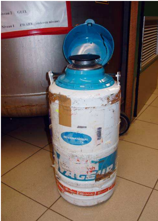
Obrázek C: Kontejner s kapalným dusíkem „dry shipper“ používaný pro mezinárodní transport psího spermatu
