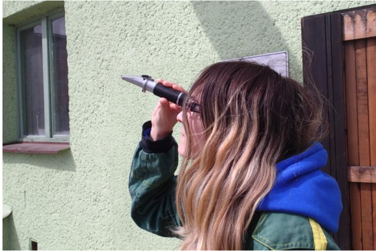
Obr. 6: Zjišťování kvality mleziva refraktometrem (pohled proti světlu)
