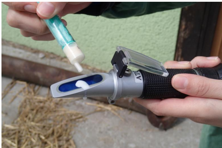
Obr. 4: Aplikace směsného vzorku na optickou část refraktometru
