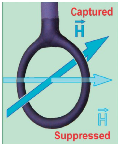
Obrázek 3.11 Sonda pro měření intenzity magnetického pole a její frekvenční charakteristika [15]
