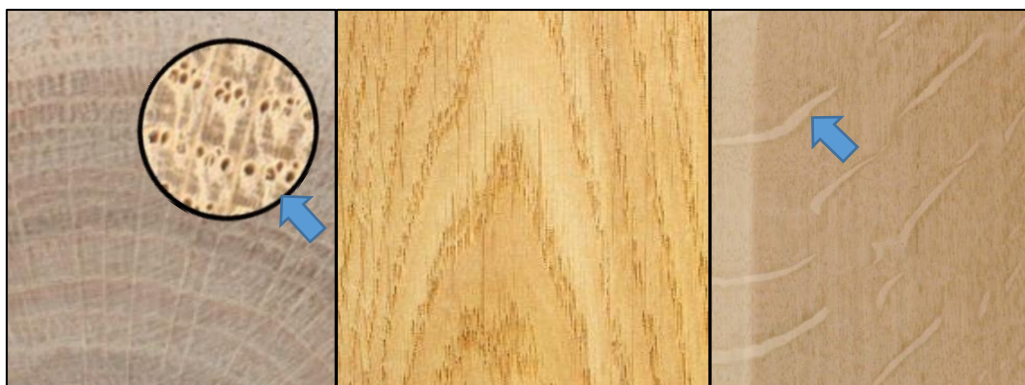
Obrázek č. 3 Mikroskopická stavba dubu letního příčný řez (vlevo), tangenciální řez (uprostřed) a radiální řez (vpravo), šipky ukazují na stříbrné odlesky a plamence (Wagenführ 2007)
