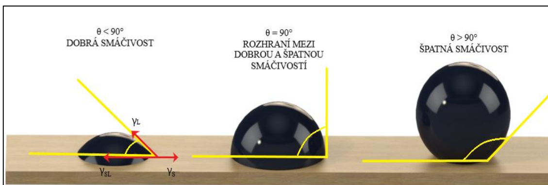
Obrázek č. 15 Příklady smáčivosti a jednotlivé složky energií: \gamma_S povrchová volná energie pevného materiálu, \gamma_L – povrchová energie kapaliny, \gamma_{SL} – povrchová energie na hranici pevného materiálu a kapaliny (Kúdela 2014).
