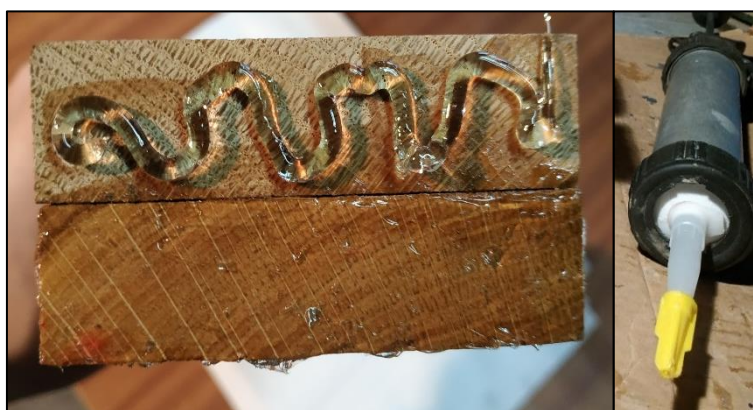
Obrázek č. 13 Nanášení silikonu na čelních plochy vzorků
