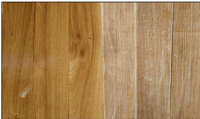
Obrázek č. 12 Ruční broušení vzorků po vytvrzení (vlevo před a vpravo po broušení)
