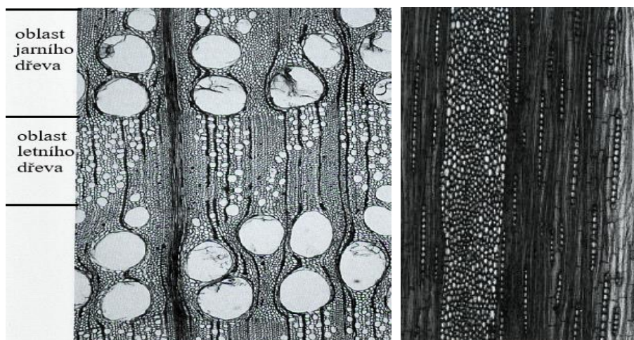
Obrázek č. 4 Mikroskopické řezy 40x zvětšeno, příčný řez (vlevo), tangenciální řez (vpravo) (Wagenführ 2007).
