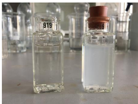
Obrázek 2. Důkaz přítomnost síranů ve vzorku vody (Foto Autor, 2017)
