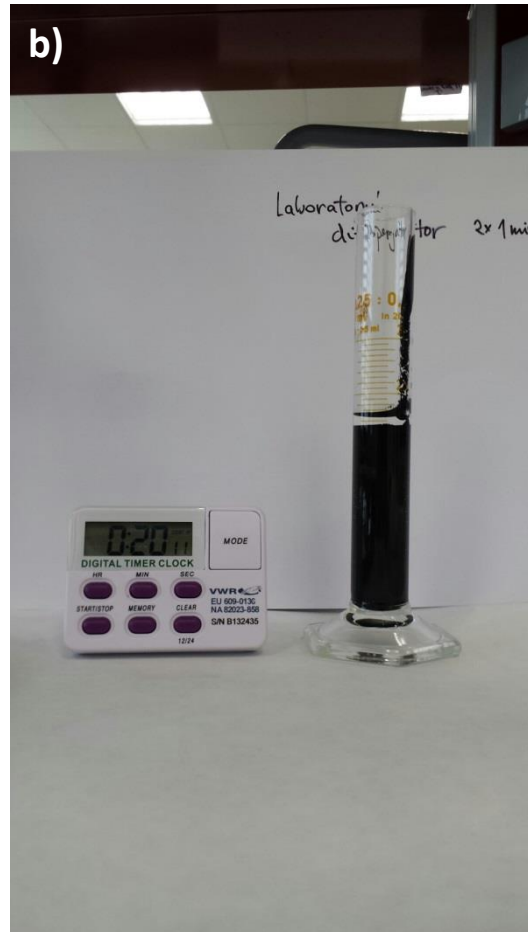
Obrázek 3.4.1: Rychlost sedimentace ve válci po dispergaci homogénizátorem IKA ULTRA-Turrax v čase 0 minut (a) a 20 minut (b). Příklad dobré dispergace.
