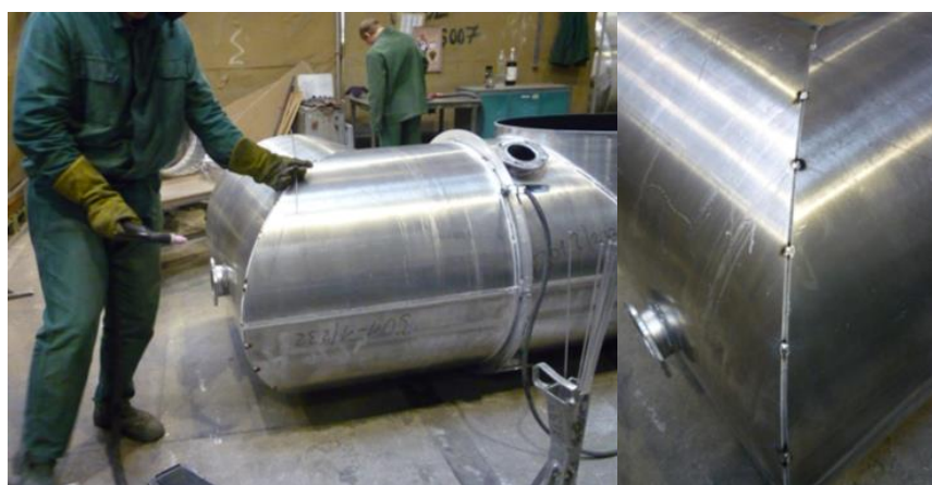
Obrázek 30: Bodový svar WIG při výrobě zapouzdřených vodičů v EGE, s. r. o. [vlastní zdroj]
