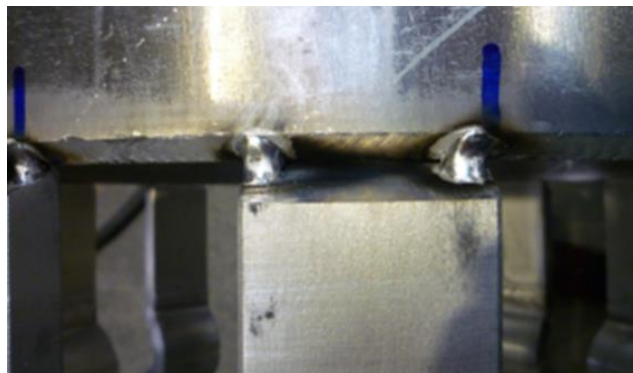
Obrázek 29: Bodování před svařováním WIG v EGE, s. r. o. [vlastní zdroj]
