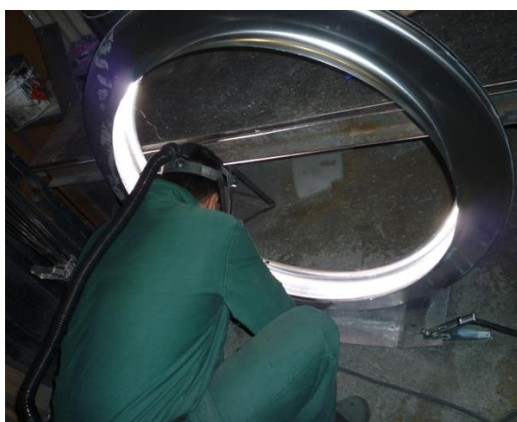
Obrázek 45: Svařování na podložku WIG v EGE, s. r. o. [vlastní zdroj]
