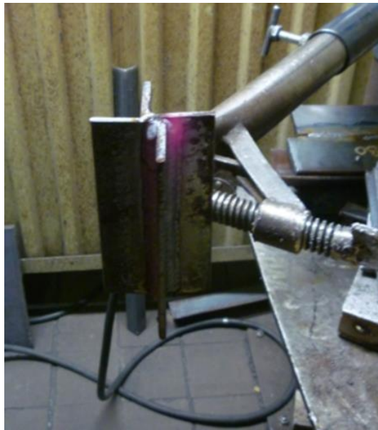
Obrázek 32: Koutový svar v EGE, s. r. o. [vlastní zdroj]
