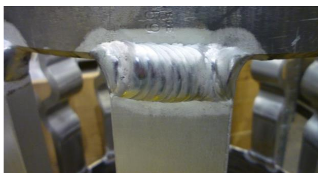
Obrázek 31: Dokončovací operace WIG v EGE, s. r. o [vlastní zdroj]
