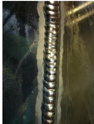
Obrázek 37: Svarová housenka MIG [vlastní zdroj]
