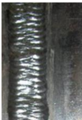
Obrázek 48 : Krycí vrstva tupého svaru poloha PF Plech 12 mm [36]
