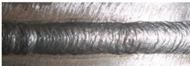
Obrázek 49: Krycí vrstva tupého svaru poloha PA Plech 12 mm [36]
