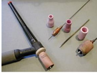
Obrázek 60: Svařovací hořák s elektrodami, měděnými kontaktními špičkami a keramickými (růžovými) plynovými hubicemi [35]
