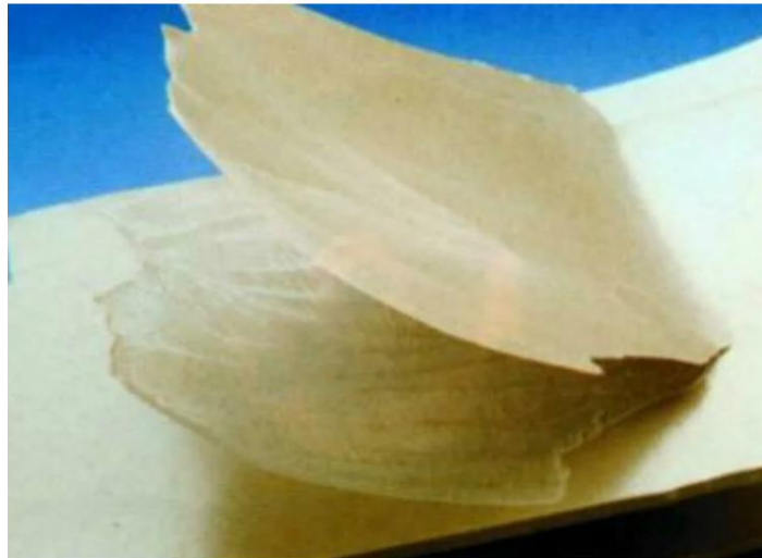
b) delaminace povrchu výstřiku
