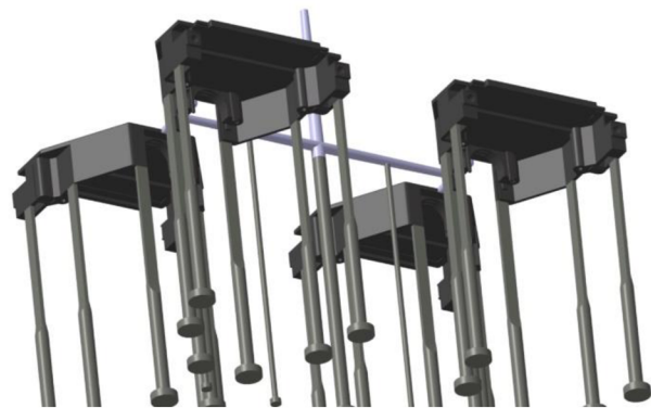
b) poloha vyhazovačů na výrobcích
