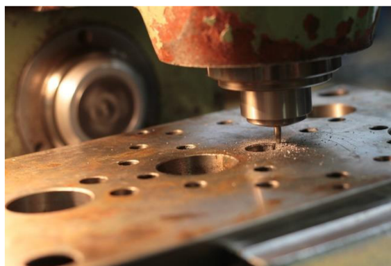
Obr. 72 Frézování vstřikovací formy [45]
