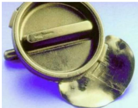
c) přetok plastového výrobku
