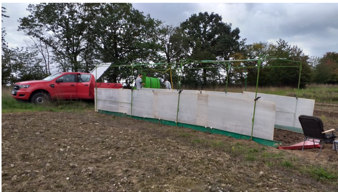
Obrázek 1: Polní simulátor deště využívaný ve Výzkumném ústavu meliorací a ochrany půdy, v. v. i. (2019), autor: David Kabelka.
