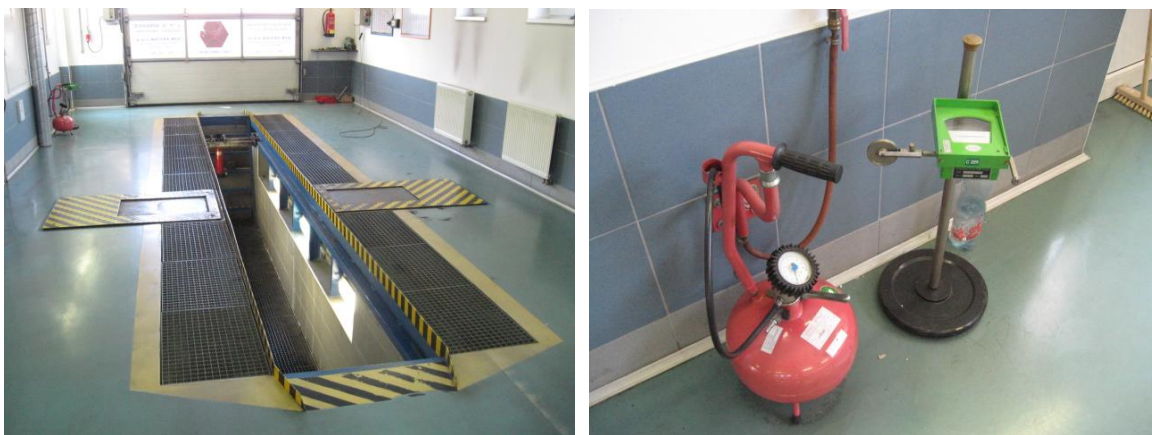
Obr. 13,14 První stání STK MI. Boleslav a přístroj na měření házivosti, přístroj na kontrolu tlaku v pneumatikách
