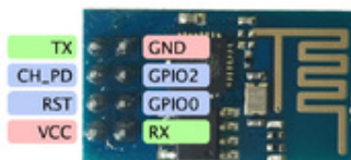
Obrázek 3.7 Rozložení vývodů ESP8266
