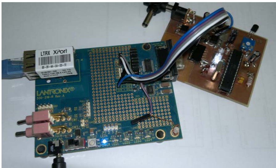
Obrázek 3.6 Připojení TCP/IP převodníku pro vyzkoušení komunikace
