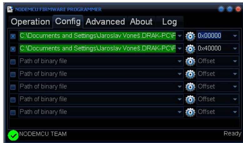
Obrázek 3.13 Nastavení konfigurace flasheru
