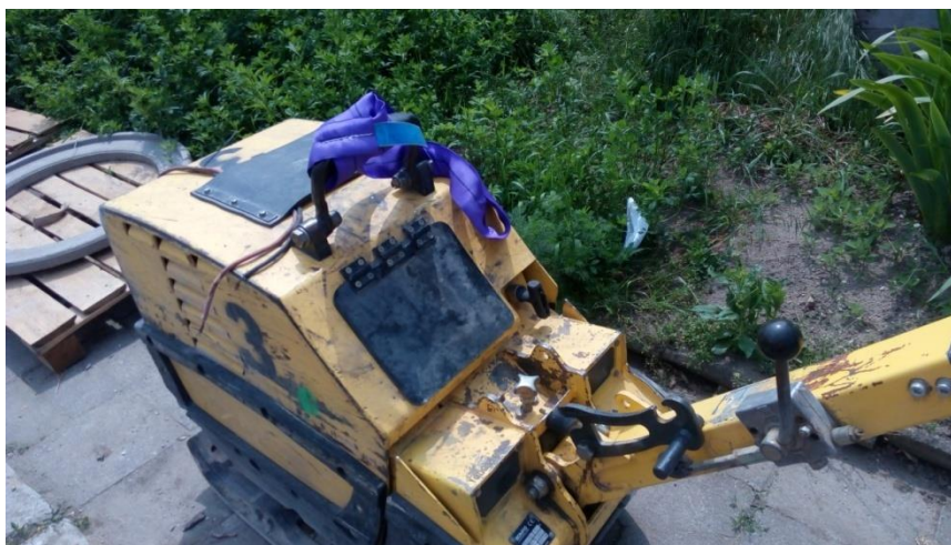
Obrázek 19 - Správný úvazek na vibrační desce, zdroj: vlastní
