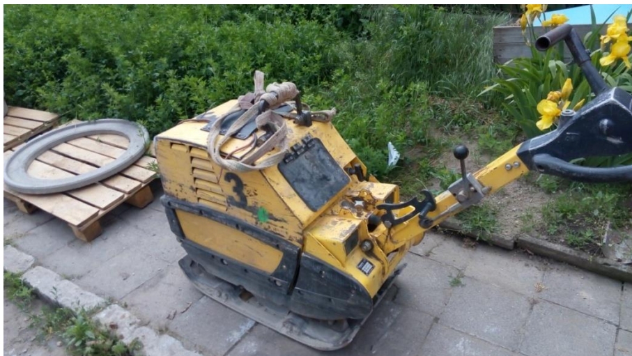
Obrázek 18 - Poškozený úvazek na vibrační desce, zdroj: vlastní
