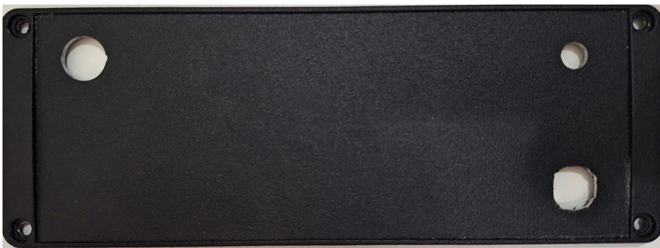
Obrázek 3.4: Zadní panel s vyfrézovanými otvory
