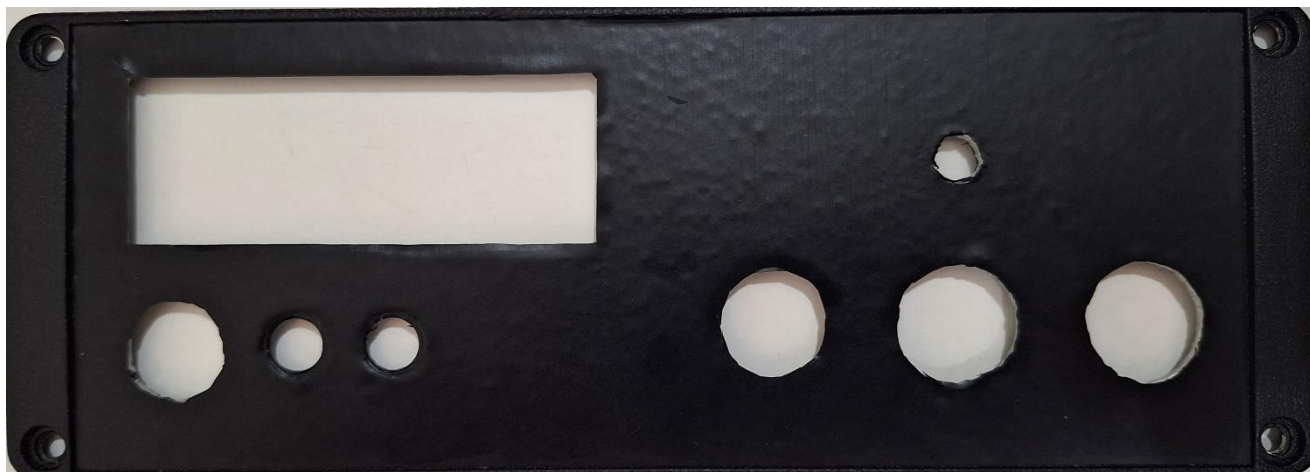
Obrázek 3.3: Přední panel s vyfrézovanými otvory
