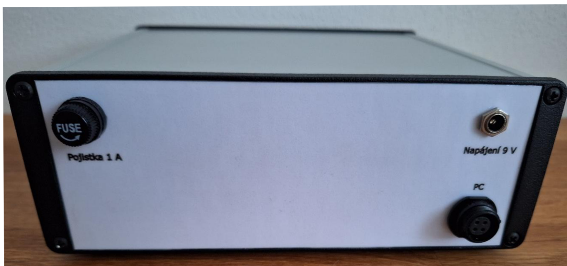
Obrázek 6.2: Finální podoba zdroje zadní část
