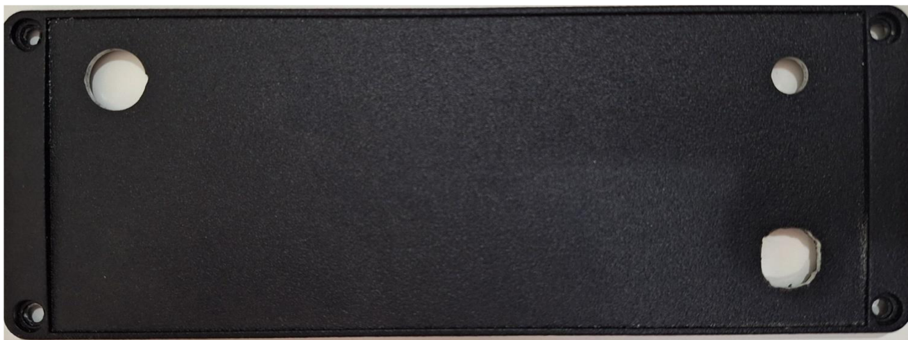
Obrázek 3.4: Zadní panel s vyfrézovanými otvory
