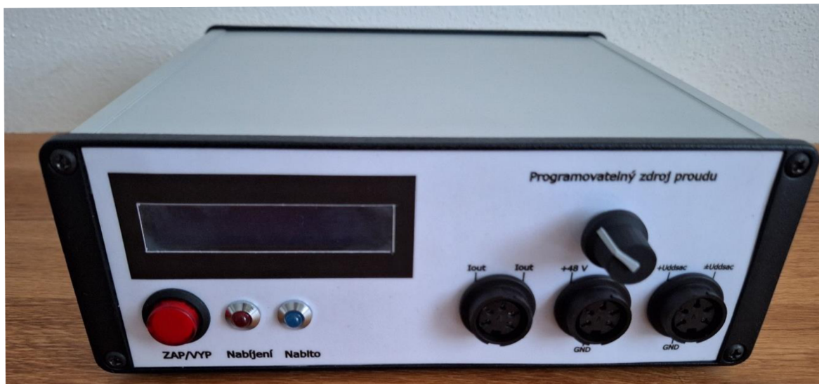
Obrázek 6.1: Finální podoba zdroje přední část
