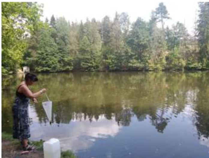
Obrázek 10 Kunratické rybníky 26. 7. 2021 - sběr vzorků pomocí planktonní sítě
