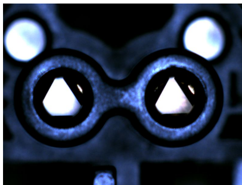
Obr. 3.1: Snímek konektoru po výměně osvětlení a objektivu
