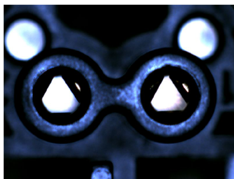
Obr. 3.1: Snímek konektoru po výměně osvětlení a objektivu
