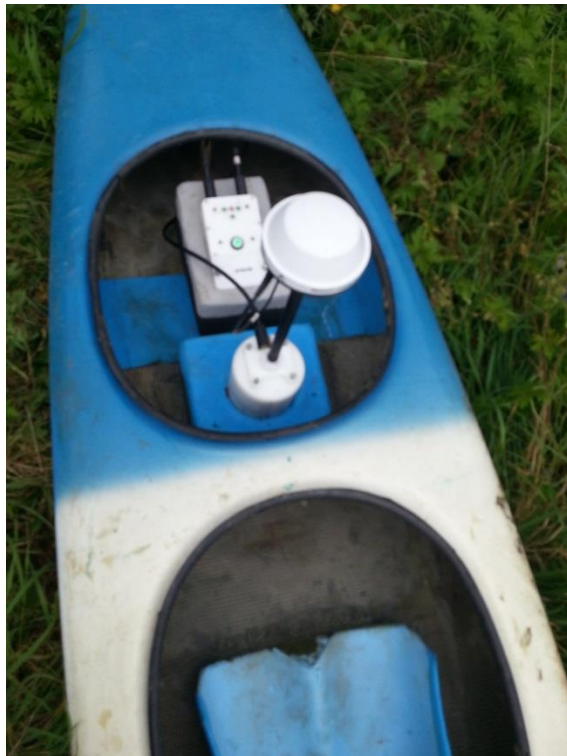
Příloha 3: Měřicí loď s namontovaným přístrojem RiverSurveyor (vlastní)
