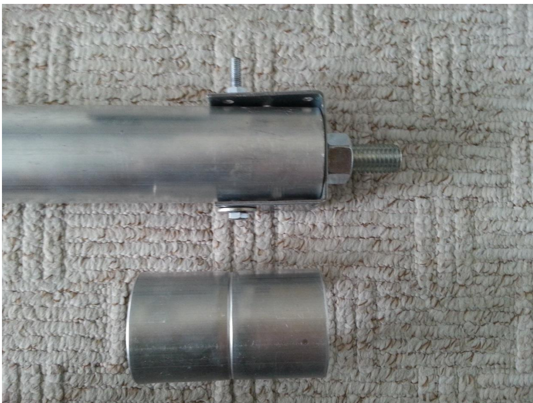
Příloha 9: Detail šroubu k uchycení GPS přijímače a převlečné spojky (vlastní)
