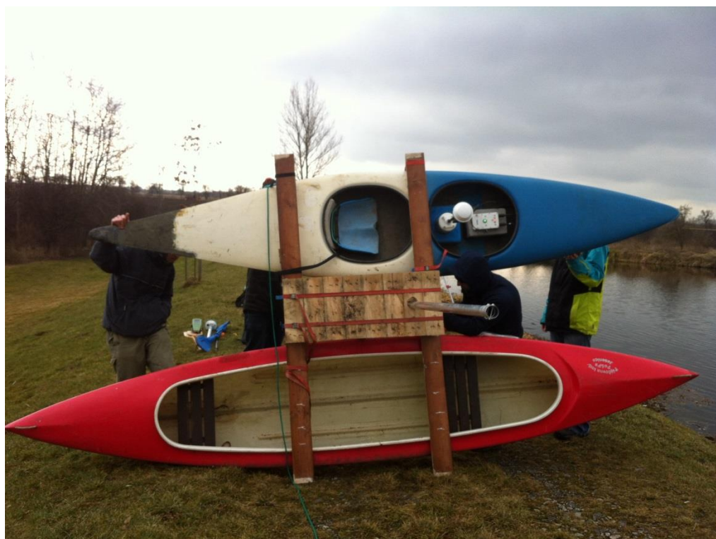
Obrázek 21: Soulodí (uprostřed středové konstrukce lze vidět měřící soutyčí) (vlastní)
