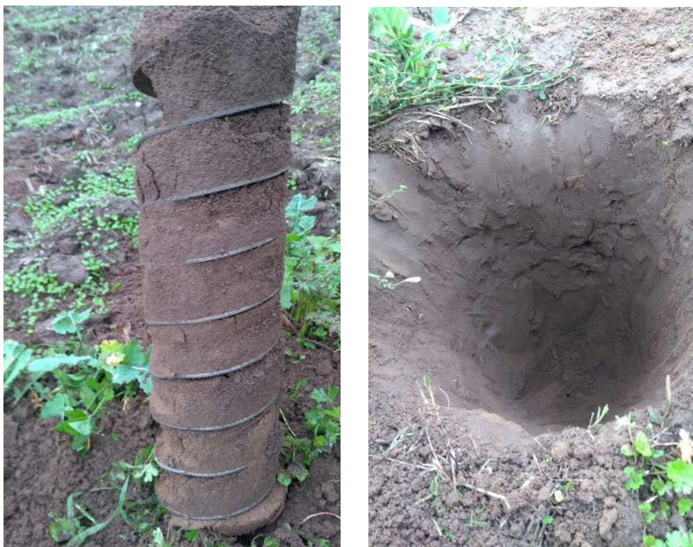
Obr.č.4: foto z odběru půd – spirálovitá odběrová tyč, odběrové místo
