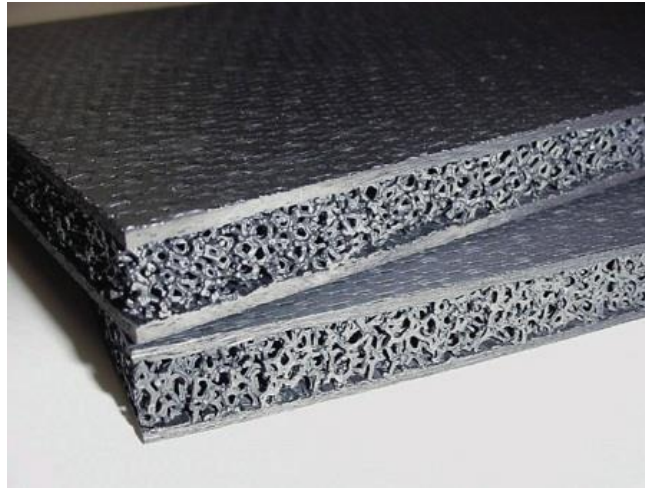
Obr. 2.11 Příklad potahu z vláknového kompozitu s keramickou maticí (C/SiC) [20].
