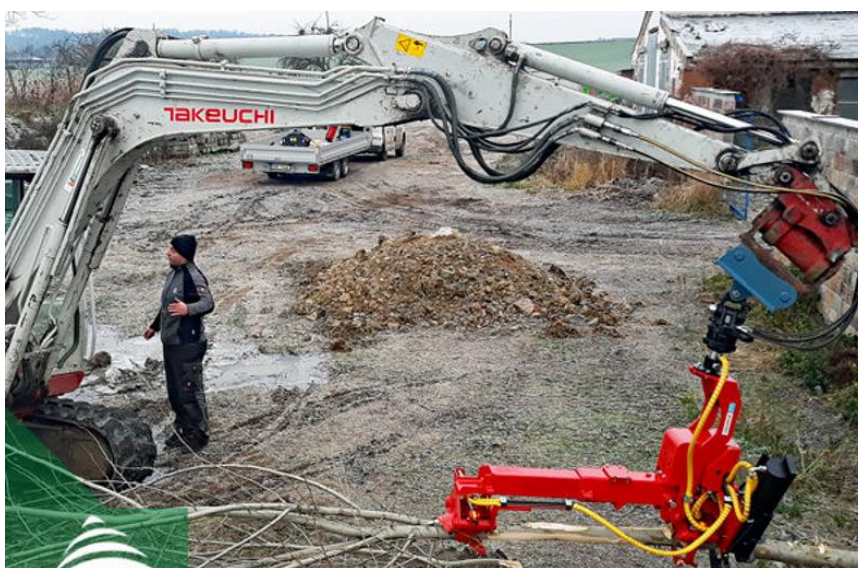
Obr. 14 Konstrukce nástavce jako svařenec s okem [30]
