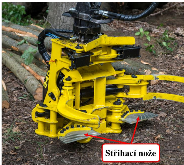
Obr. 8 Konstrukce harvestorové hlavice se střihacími noži [18]
