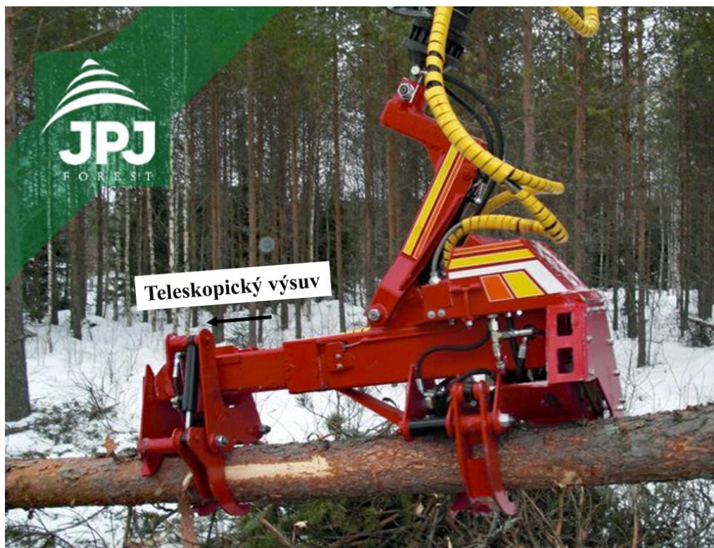
Obr. 5 Konstrukční provedení harvesterové hlavice s podávacím teleskopem [14]
