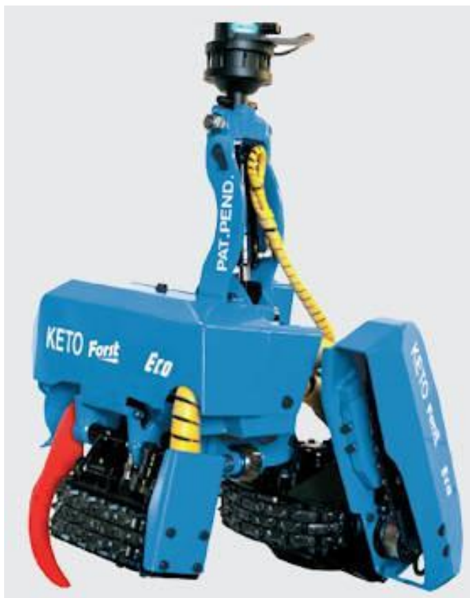
Obr. 4 Konstrukční provedení harvesterové hlavice s podávacími pásy [13]
