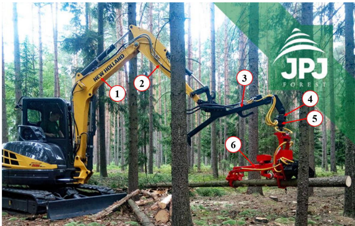
Obr. 1 Popis sestavy rypadla pro jeho užití v lesní těžbě [5]
