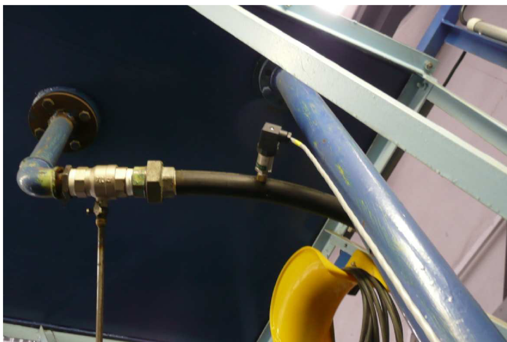
Fotografie 2. Experiment – detail uzávěru V_1 s tlakovým snímačem P_1
