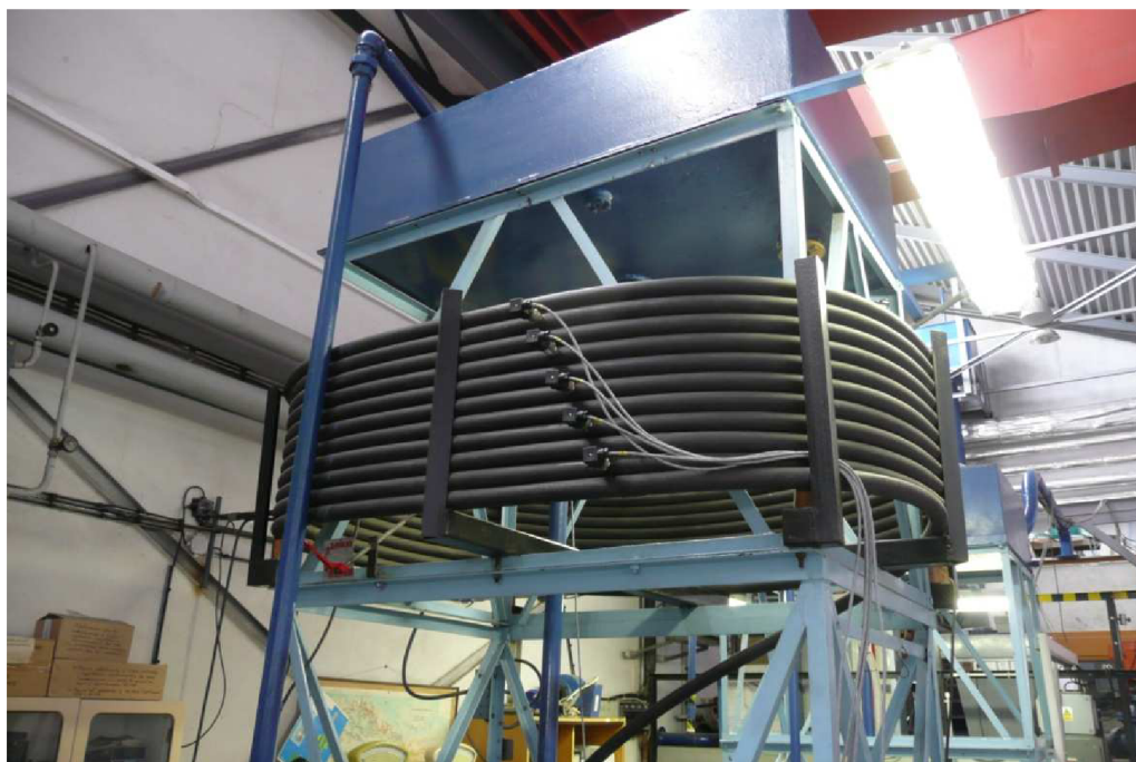
Fotografie 1. Experiment – rozmístění snímačů tlaku P_2 - P_6
