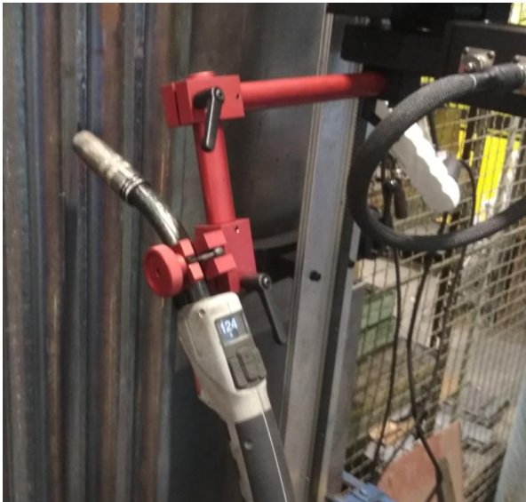
Obr. 4.1 Vlevo: Svařovací hlavice pro testovací navařování, Vpravo: Navržené uchycení hořáku pro optimalizaci (základní design, rozměry v mm)
