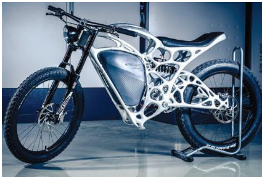
Obr. 3.1 Ukázka možností topologické optimalizace [27]
