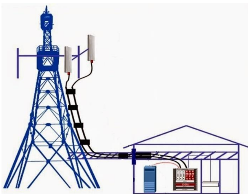
Obrázek 12 – Indoor instalace eNodeB (vnitřní rádiové moduly) [16]
