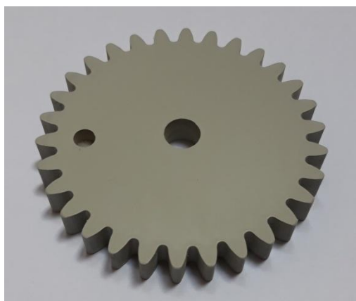
Obr. 4.14 Ozubené kolo po aplikaci plniče.
