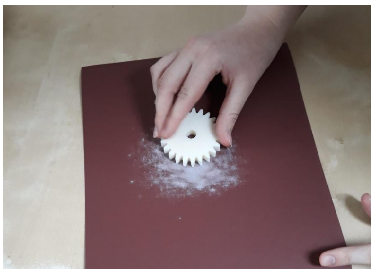
Obr. 4.13 Broušení ploch brusným papírem.
