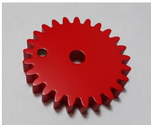
Obr. 4.15 Ozubené kolo po aplikaci barevného laku.
