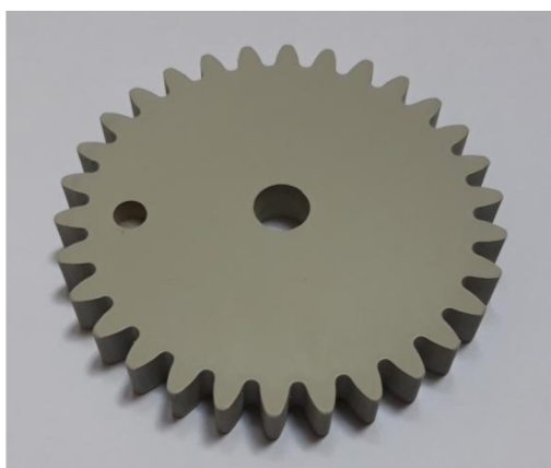
Obr. 4.14 Ozubené kolo po aplikaci plniče.
