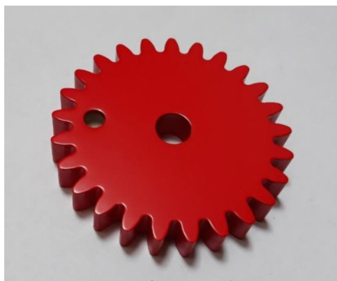
Obr. 4.15 Ozubené kolo po aplikaci barevného laku.
