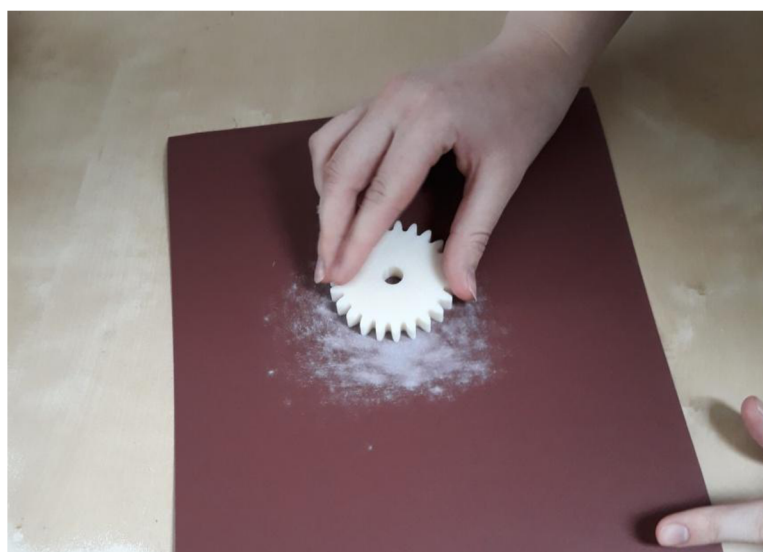
Obr. 4.13 Broušení ploch brusným papírem.
