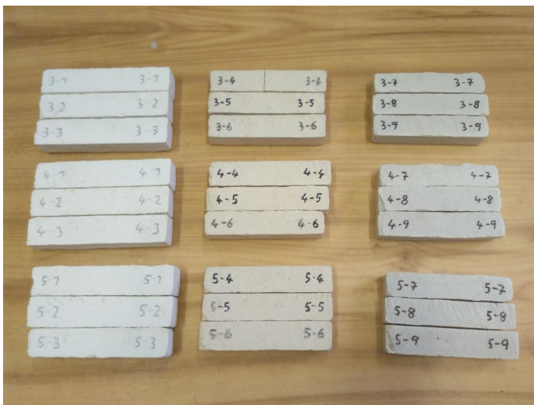
Obrázek 27: Fotografie výsušků a vypálených vzorků. Levý sloupec výsušky na 105 °C. Prostřední sloupec vzorky vypálené na 1250 °C. Pravý sloupec vzorky vypálené na 1350 °C
