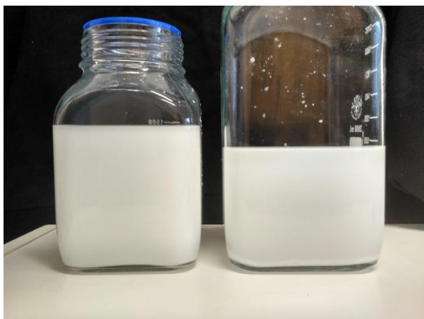
Obrázek 23: Snímek suspenzí po rozmíchání. Na levé straně Al_2O_3 nanovláčka, SiO_2 na pravé straně
