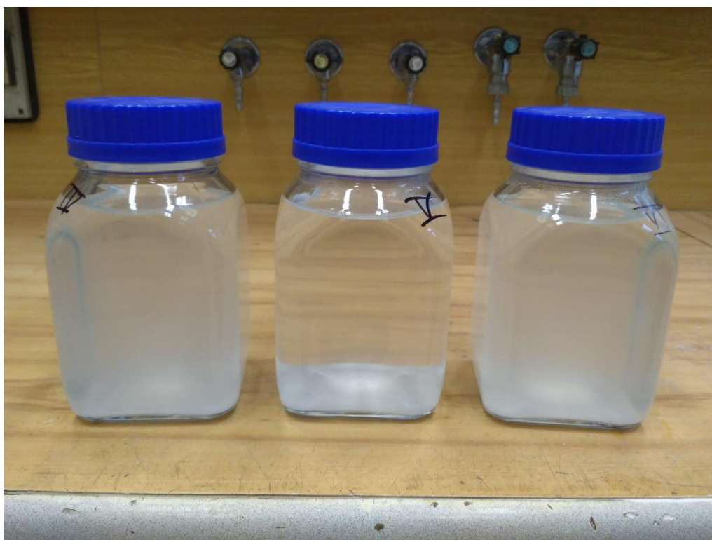
Obrázek 20: Porovnání stability nanovlákněné suspenze SiO 2 s jednotlivými typy stabilizátorů. (IV) vzorek s vodním sklem, (V) hexametafosforečnan sodný, (VI) škrob
