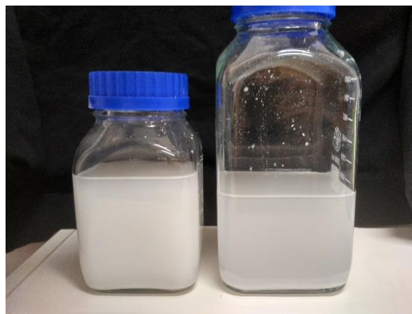
Obrázek 24: Snímek suspenzí po 3 hodinách. Na levé straně Al_2O_3 nanovláčka, SiO_2 na pravé straně.
