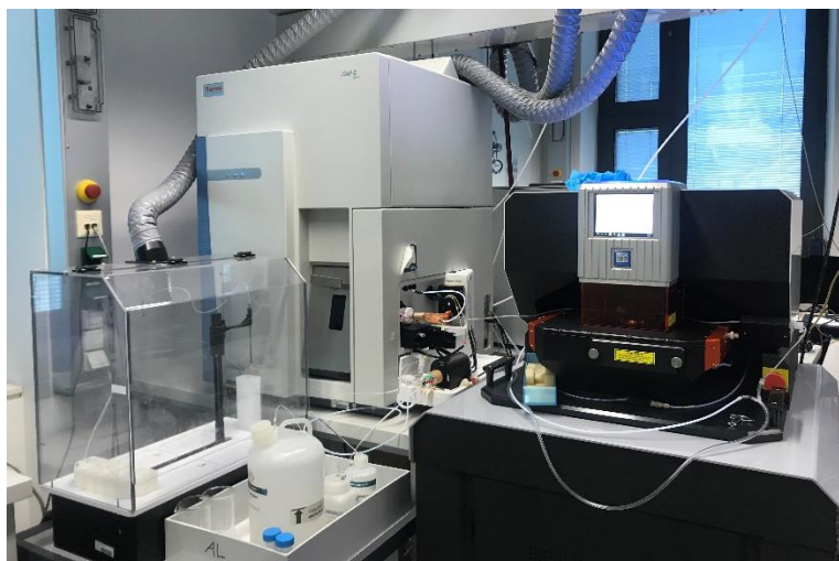
Obrázek 24: Měřicí sestava LA-ICP-MS na Technické univerzitě ve Vídni.
