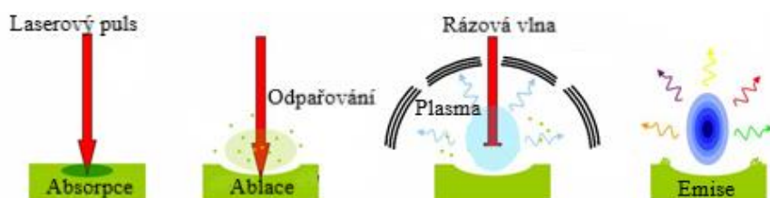
Obrázek 5: Princip metody LIBS [32].
