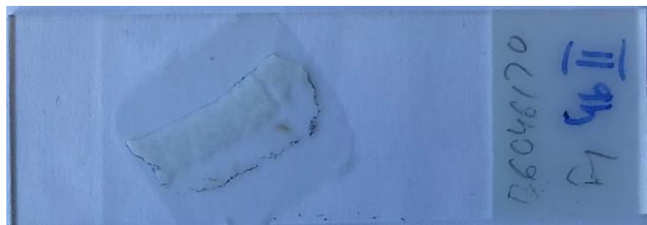
Obrázek 19: Ukázka tenkého řezu (10 µm) nádoru na laboratorním skle pro analýzu LA-ICP-MS.
