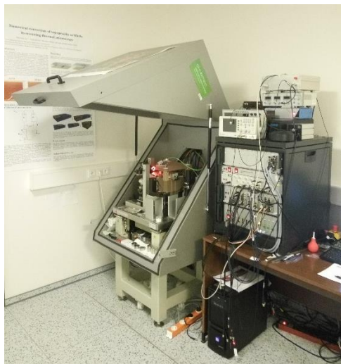
Obr. 14) SIOS NMM-1 je na ČMI umístěn v podzemí na antivibračních podložkách
