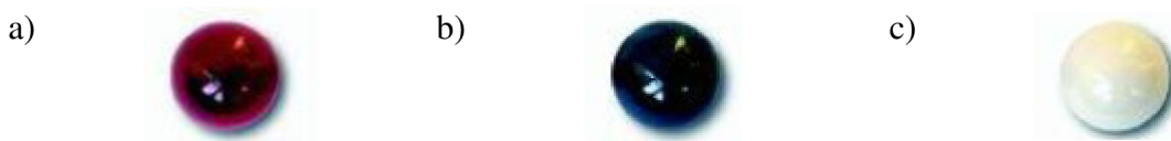
Obr. 21) a) rubín, b) nitrid křemíku, c) zirkon [42]
