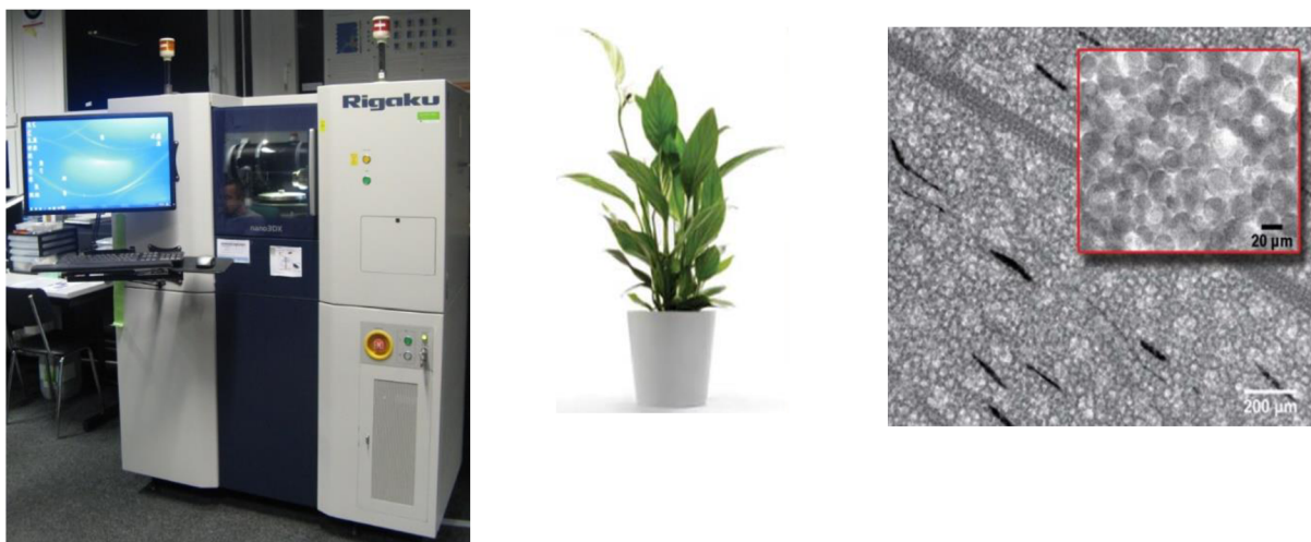
Obr. 11) Rigaku nano 3DX (vlevo), snímek listu pokojové květiny – optimalizace kontrastu v krátkém čase (60 sekund) patří k nejvýznamnějším vlastnostem Rigaku nano3DX (vpravo) [23][24]
