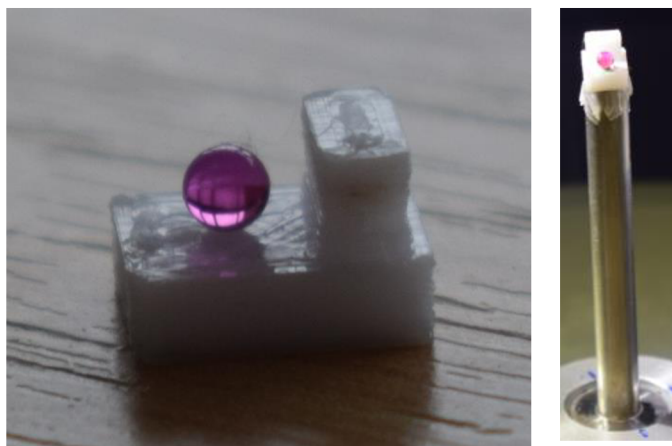
Obr. 35) Prototyp prvního návrhu artefaktu pro zorné pole 5,6 × 7,2 mm s kuličkou o průměru 2 mm (vlevo) a jeho upevnění na přípravek (vpravo)
