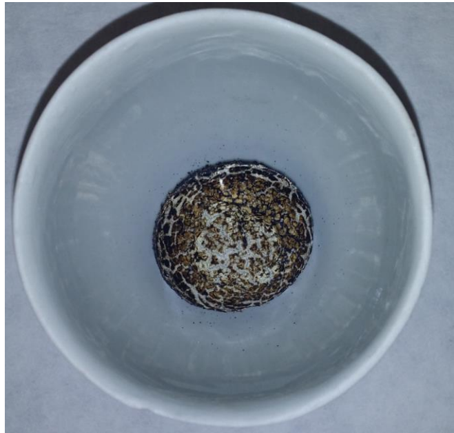
Obrázek 23: Oxid ceričitý po pálení na 400 °C vytvořil strukturu „křepelčího vejce.“
