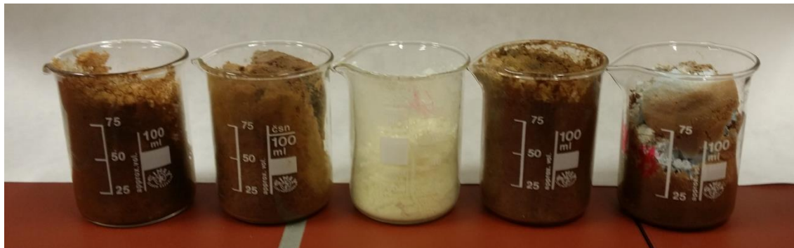
Obrázek 27: Oxidy vzácných zemin po pálení na 400 °C. Struktura je velmi nadýchaná a stále znečištěná organickými zbytky.
