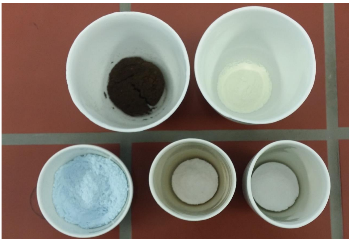
Obrázek 28: Oxidy vzácných zemin po pálení na 650 °C. Vlevo nahoře oxid praseodymito – praseodymičitý, vpravo oxid ceričitý. Spodní řada zleva oxid neodymitý, oxid lanthanitý a oxid gadolinitý.
