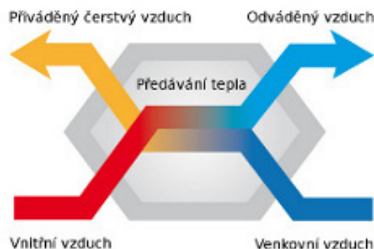
Obrázek 1 Princip zpětného získávání tepla
