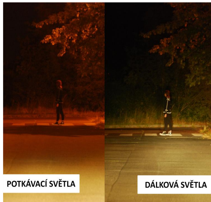
Obr. 70 Odrazivost RN 3 v reálném prostředí na přechodu na 50 m - varianta 1
