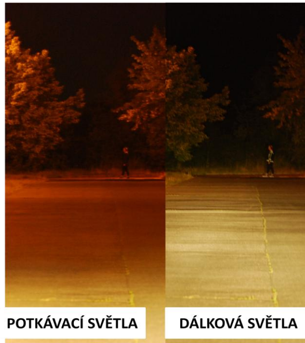
Obr. 75 Odrazivost RN 3 v reálném prostředí na přechodu na 100 m - varianta 3
