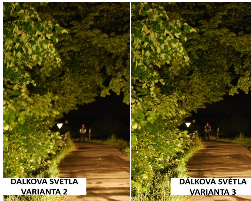
Obr. 63 Odrazivost RN 3 v reálném prostředí za úplné tmy na 100 m - varianta 2 a 3
