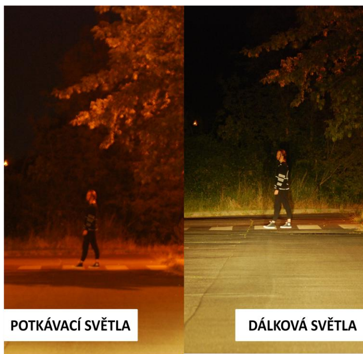
Obr. 71 Odrazivost RN 3 v reálném prostředí na přechodu na 50 m - varianta 2
