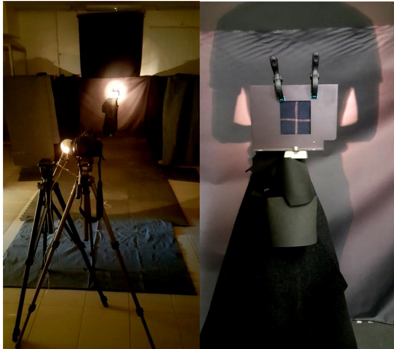
Obr. 28 Zatemnění místnosti a upnutí kruhového vzorku pro měření odrazivosti – metodika 1
