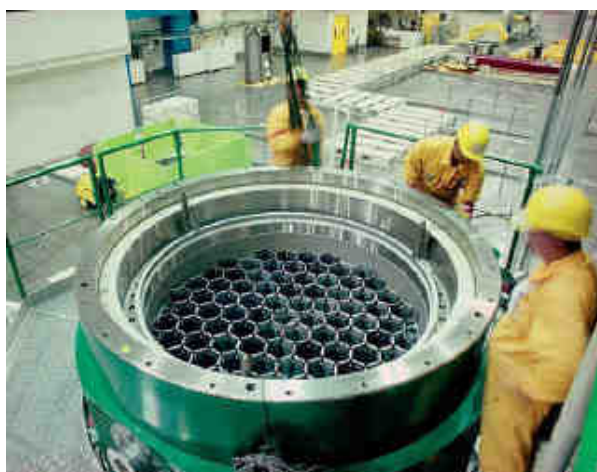
Obrázek 15 Pohled do otevřeného OS CASTOR [23]
