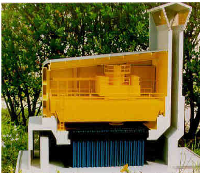
Obrázek 20 Svislý řez modelem skladu Paks [25]
