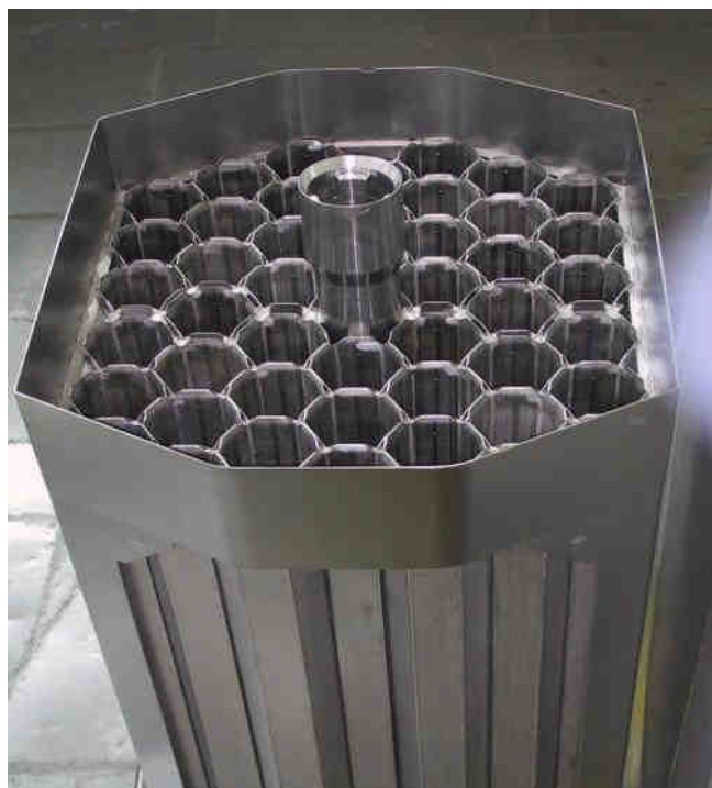
Obrázek 21 Nerezový koš pro vyhořelé palivo [26]
